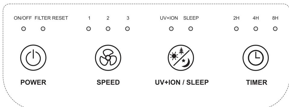
Панель управления воздухоочистителя «АТМОС-БЕНТ-1550» состоит из следующих клавиш и соответствующих им индикаторов:
